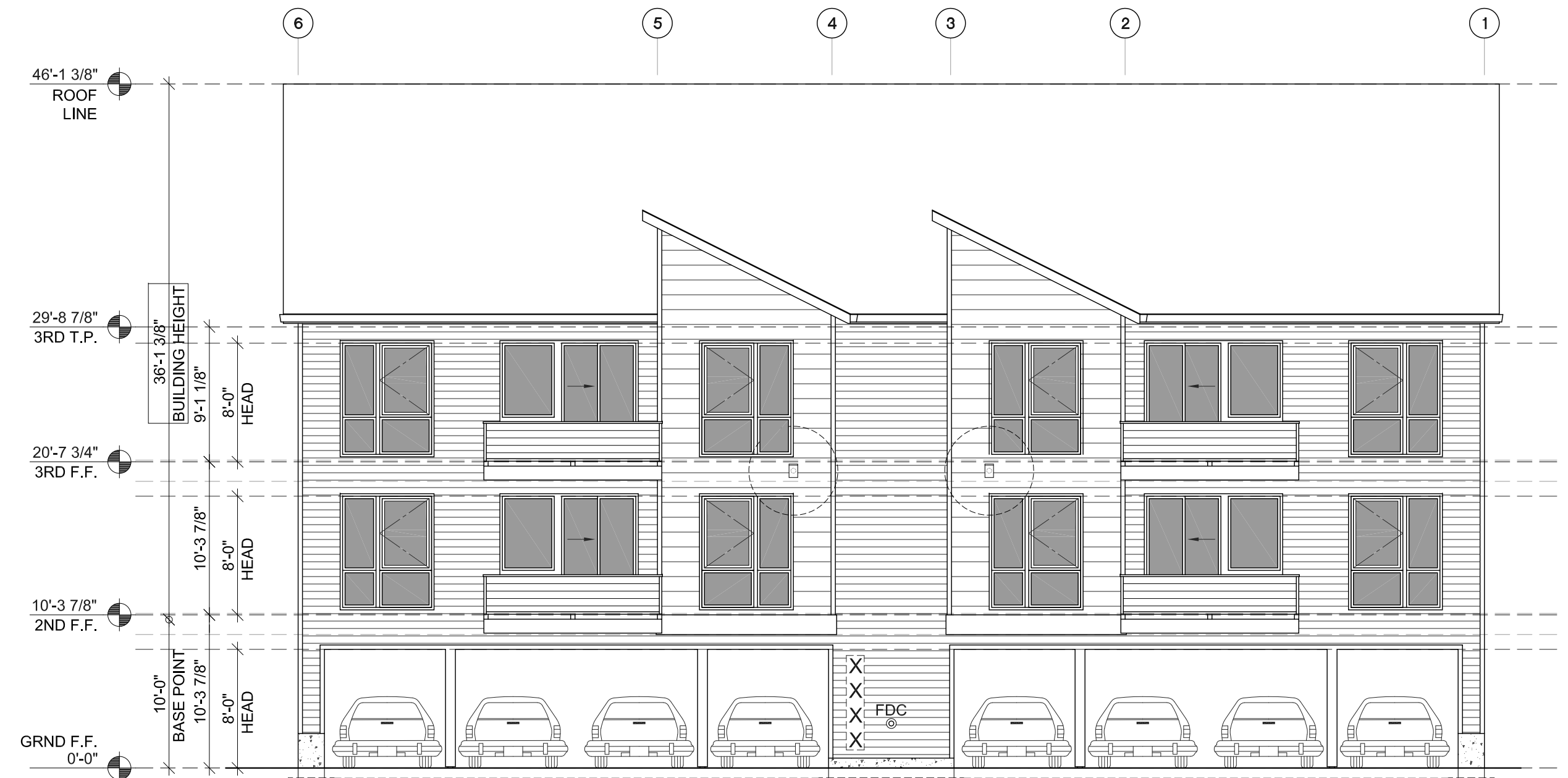
44 BLDG A - FRONT/NORTH ELEVATION A5.0-A SCALE: 1/8" = 1'-0"
